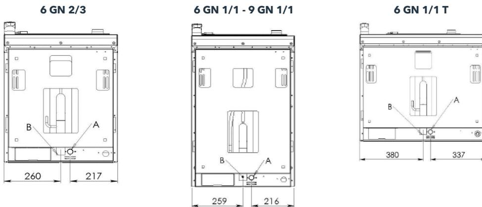
**A** Connexion 3/4" eau traitée      **B** Drainage DN 40
