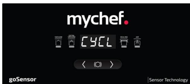
**Figura 6. Visualización del número de ciclos de vacío realizados**
