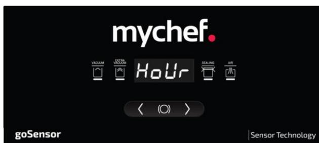
**Figura 5. Visualización de las horas de funcionamiento de la bomba de vacío**
