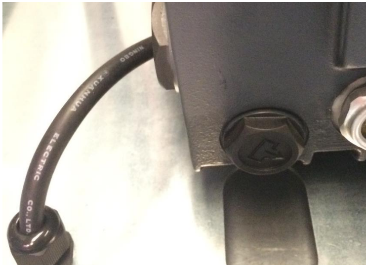
Ilustración 5. Quitar el tapón de vaciado del aceite
