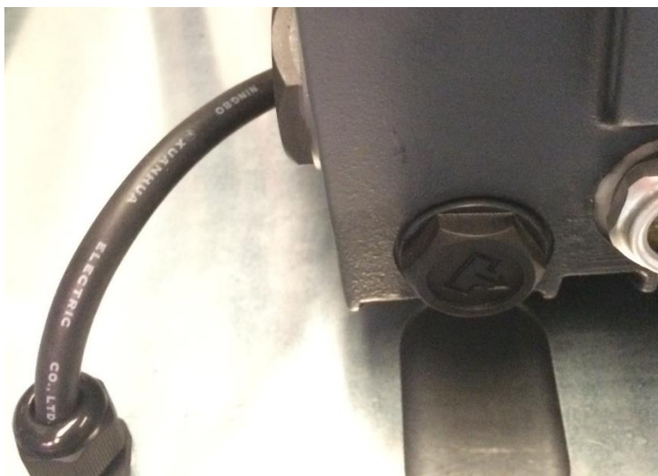
Illustration 5. Retirer le bouchon de vidange de l'huile
